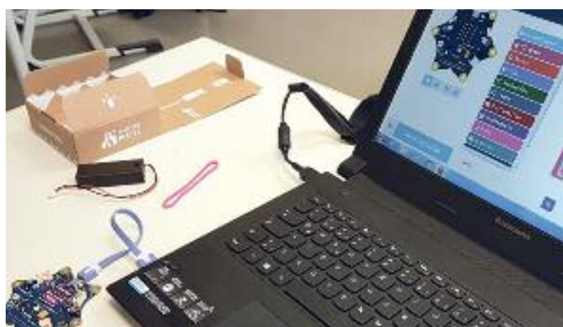
Mit dem „Calliope Mini“, der LEDs, Buttons, zahlreiche Sensoren und eine Bluetooth-Funktion hat, wurde in einem Workshop eine Alarmanlage spielerisch programmiert. (Foto: Schulte)
