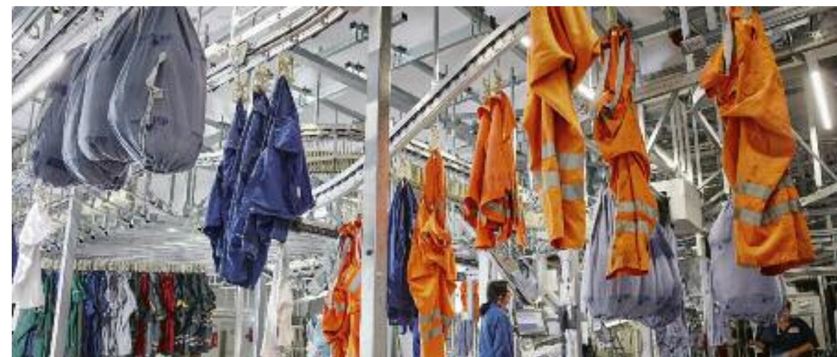
In den weitläufigen Produktionshallen der Böge Textil-Service GmbH muss man in „Deckung“ gehen, wenn über, neben und vor einem vollautomatisch Kleidungsstücke schweben. Rund 9.000 Teile durchlaufen pro Tag die Kette aus Transportieren, Sortieren, Waschen, Trocknen, Bügeln, Falten, Ausbessern, Veredeln und Verladen. (Alle Fotos: DBL Böge)
