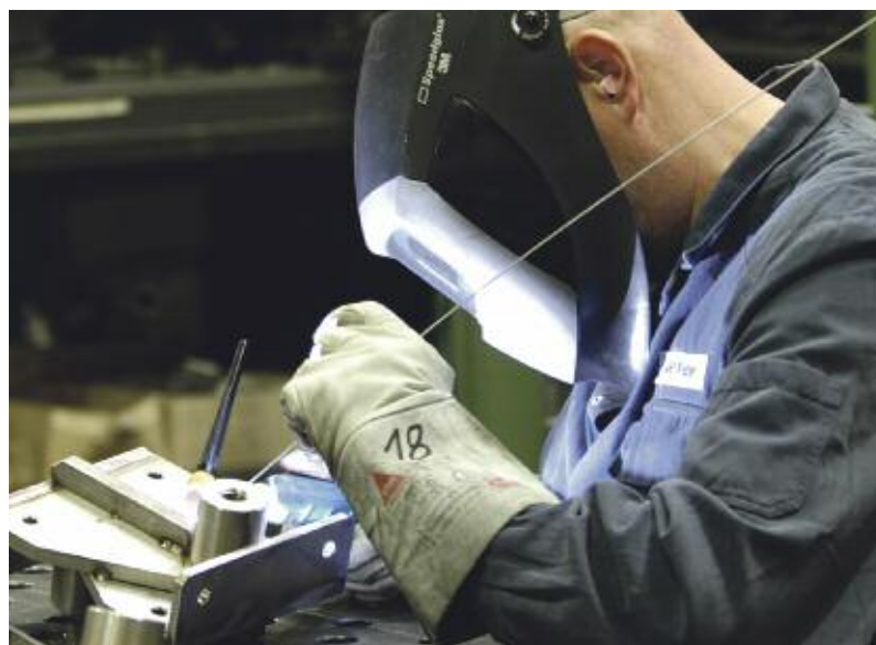
50 DUESING-Mitarbeiter bearbeiten Blechteile und Gehäuse in vielen Arbeitsschritten: lasern, entgraten, stanzen, kanten, schweißen, schleifen, prägen, pulverbeschichten und lackieren. (Fotos: Middelkamp)
