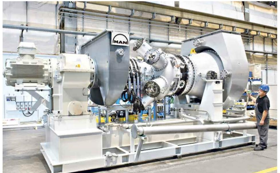
Die in Oberhausen hergestellten Gasturbinen werden als Komplettpaket aufgebaut und laufen an Testständen unter realen Bedingungen. (Alle Fotos mit freundlicher Genehmigung von MAN Diesel & Turbo)
