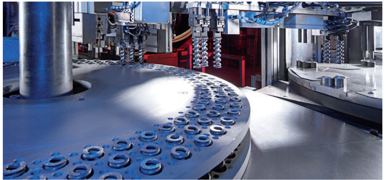
Ein Schleifroboter für die Federnherstellung – 4.000 unterschiedliche Produkte stellt die Bocholter Pieron GmbH her. (Foto: Pieron)
