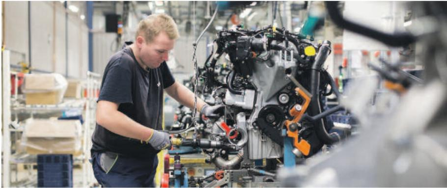
Der Logistik- und Montagedienstleister Rhenus LMK montiert vor den Werkstoren eines Kölner Automobilherstellers Motor-Getriebe-Einheiten in Sequenz. Beim Montageprozess hilft Standardisierung, z. B. einheitliche Drehmomente oder gleiche Schrauben. (Foto: LMK)
