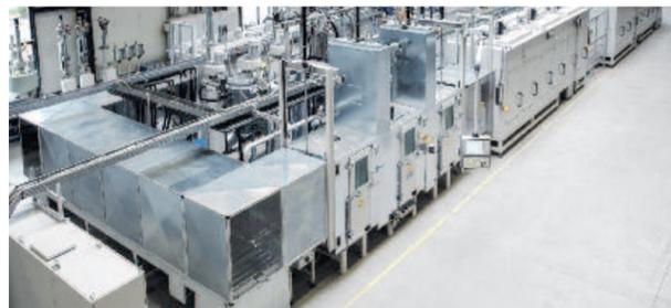
Bei HÜBERS in Bocholt werden sämtliche Anlagen vor der Auslieferung an die Kunden vollständig montiert und in Betrieb gesetzt – hier eine Anlage für den Verguss gasisolierte Schaltanlagenteile für die Hochspannungstechnik.
