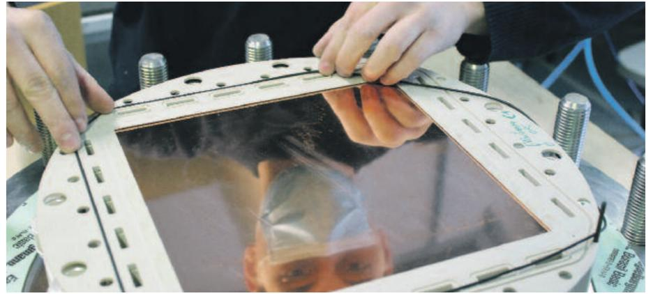
Montage eines im Energieinstitut der Westfälischen Hochschule entwickelten Zellmoduls. Der innere Aktivteil wird von einem Kunststoffrahmen eingefasst und dient der Medienzu- und -abfuhr, wobei die Anoden- und die Kathodenkreisläufe im Rahmen gegeneinander und gegenüber dem Hydraulikkreislauf zur Zellverpressung gedichtet werden. (Foto: WH/Michael Völkel)
